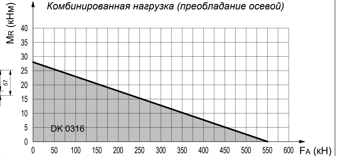
Преобладание опрокидывающей нагрузки
