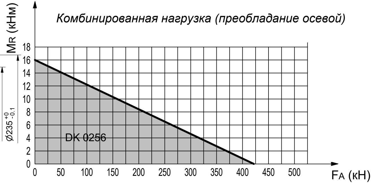
Преобладание опрокидывающей нагрузки
