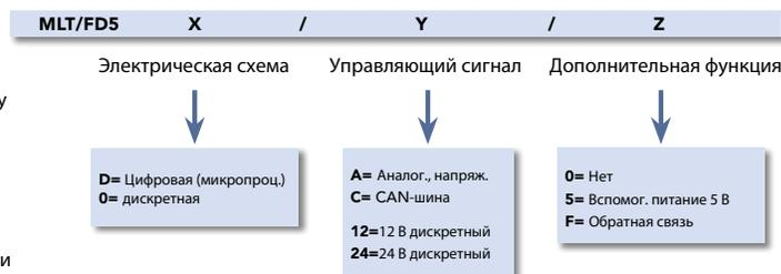
**ЭЛЕКТРОГИДРАВЛИЧЕСКОЕ ПРОПОРЦИОНАЛЬНОЕ УПРАВЛЕНИЕ С ДУБЛИРУЮЩИМ РУЧНЫМ - LMPP**
